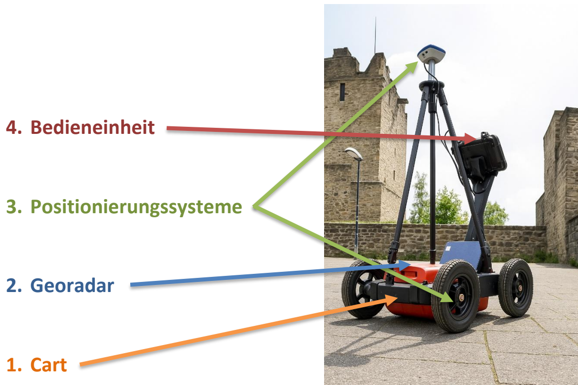
Abbildung 1: Sensorgruppen eines Multisensorcarts
